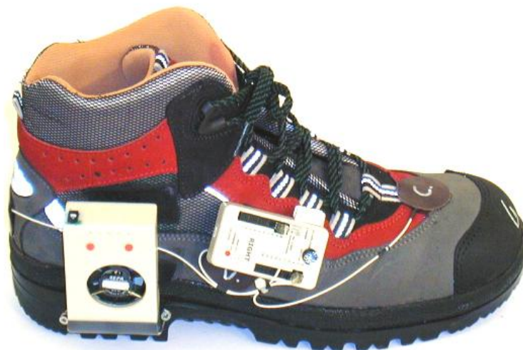
Abbildung 1: Im AiF Projekt entwickelter Lüfterschuh mit Datenlogger und Handyakku
